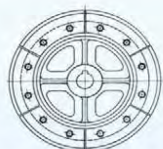
Kettenrolle mit auswechselbaren Hartgußsegmenten. Verzahnung auf Anfrage
